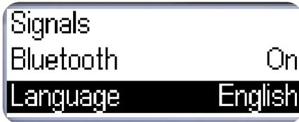
Gehen Sie in das Einstellungsmenü und verwenden Sie die Wipptasten, um nach unten zur **Language**-Option zu scrollen. Nachdem Sie die Option ausgewählt haben, drücken Sie die runde Taste, um die Sprache zu ändern (z.B. Englisch oder andere unterstützte Sprachen). Das Gerät unterstützt derzeit noch keine deutsche Sprache.
