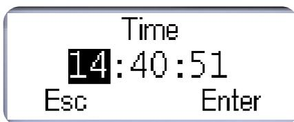
Die Zeit wird im HH:MM:SS-Format dargestellt. Drücken Sie den runden Knopf, um das gewünschte Feld auszuwählen. Um Stunden, Minuten oder Sekunden zu ändern, verwenden Sie die Wipptasten. Wenn Sie Werte schnell ändern möchten, halten Sie die obere oder untere Wipptaste gedrückt.
