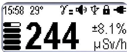
Um auf das Menü zuzugreifen, überprüfen Sie, ob das Gerät entsperrt ist. Wenn Sie
